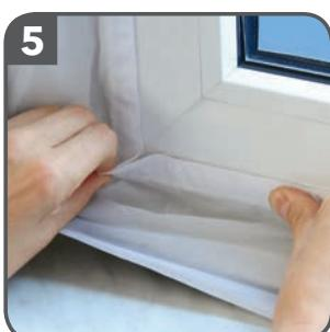
Die schmale **Seite B** (bei geschlossenem Reißverschluss) von der Mitte weg nach links und rechts bzw. nach oben und unten komplett am Fensterflügel ankleben.
